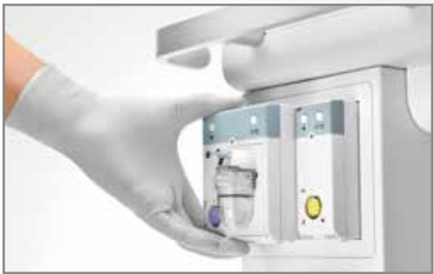
Módulos de monitoreo Plug-and-Play - Módulos opcionales de CO 2 , AG, BIS - compatibles con el monitor de paciente modular Mindray para reducir costos
