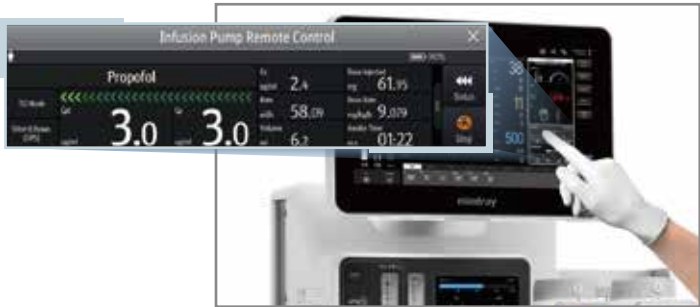
Gestione anestésicos intravenosos en la máquina de anestesia
